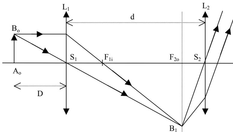
Pour que les rayons sortent de l'oculaire parallèles entre eux, il faut que l'image de l'objet rapproché  $A_0B_0$  à travers  $L_1$  se forme dans le plan focal objet de  $L_2$ .
